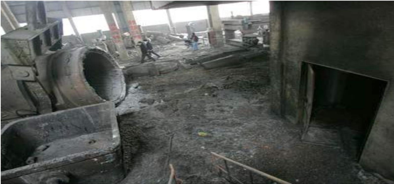
2007年4月18日，铁岭钢铁厂。脱落钢水包口直对着工人开会的小屋，很多钢水被灌入小屋，**32名工人死亡**。事故直接原因：功能失效
