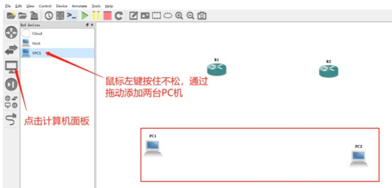
1.3 点击连接面板，用连接线将两台PC机与路由器分别相连，注意每个路由器的接口只能与一个接口相连
