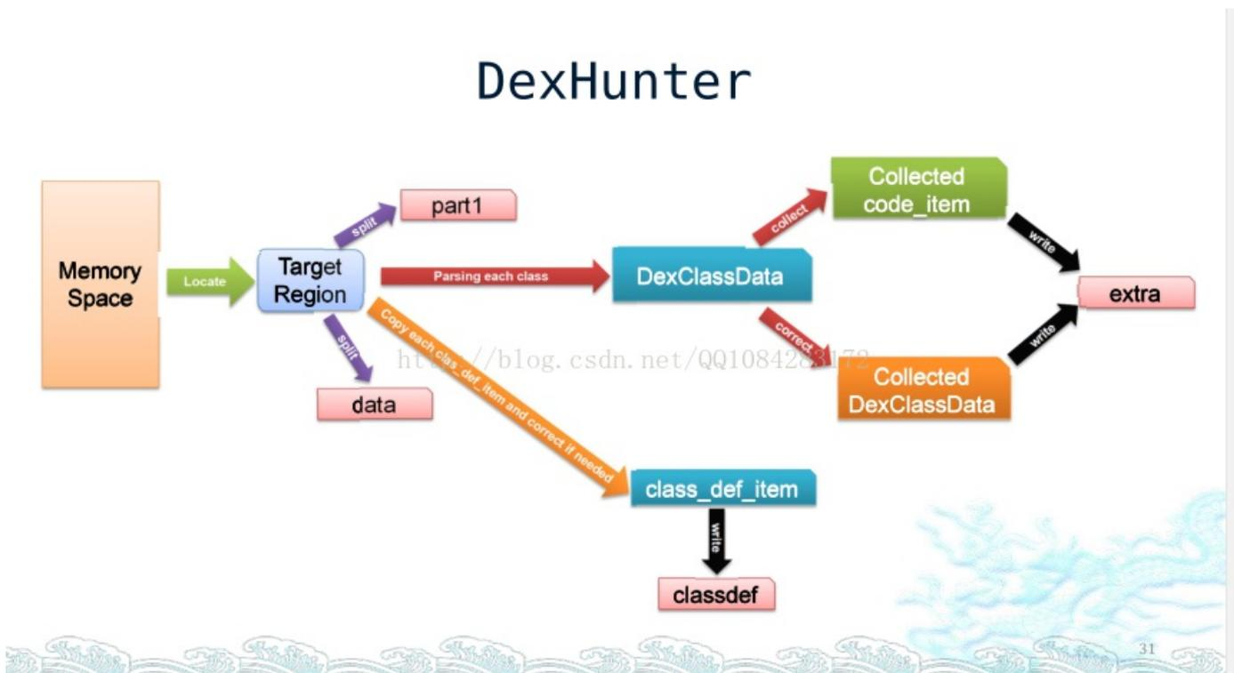
Dalvik虚拟机模式下，在目标被脱壳的Android进程内存中找到了需要dump的dex文件（实际是优化后的odex文件）所在的内存区域之后，将内存中dex文件分成3部分进行内存dump出来，然后进行dex文件的重组，最终得到能够进行逆向分析的dex文件。将目标被脱壳的Android进程内存中 odex文件开头到class\_defs开始之前这段内存区域的数据 内存dump保存到 part1文件中；将从 class\_defs的结尾开始到整个odex文件结尾之间的这段内存数据 内存dump操作保存到 data 文件中；dex文件中最关键的类信息描述结构体数据，以 Android运行时的类填充数据为准，从内存中进行收集和整理，类定义的描述结构体DexClassDef的数据收集之后内存dump保存到 clasdef文件中，类实际的填充数据DexClassData和类方法的实际数据DexCode则按照偏移的格式保存到extra文件中，最后进行odex文件的重组。
