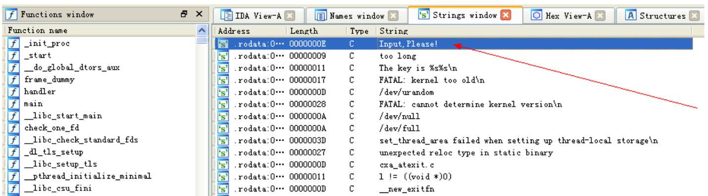
跳到字符串调用处F5, 此时可以清晰的看到整个程序的过程
