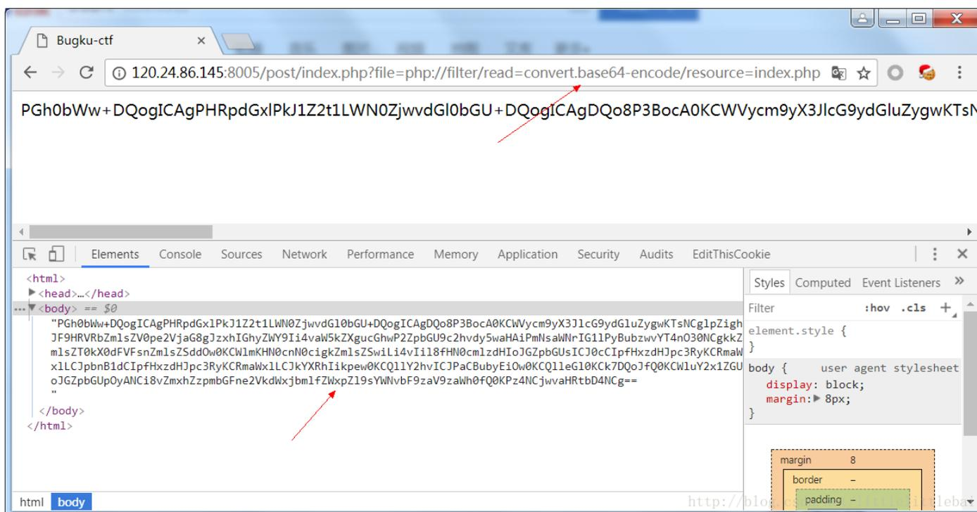
将index.php文件以base64编码形式输出，将输出内容解码，即查看到index.php的全部源码。如图。
