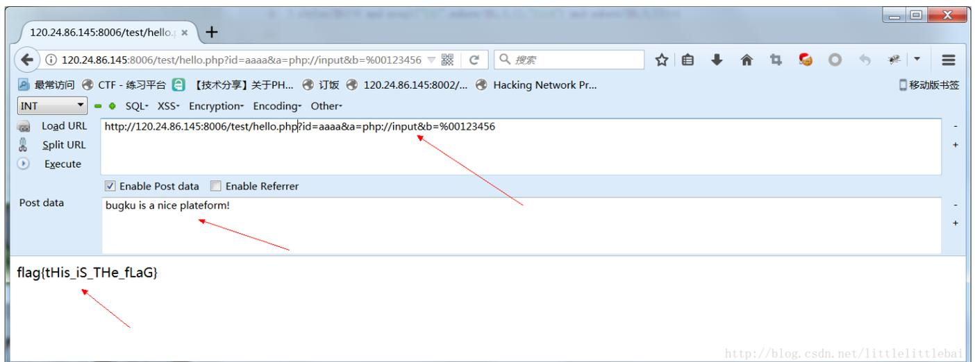
`$data = @file_get_contents($a,'r');` 这里利用了 `file_get_contents()` 函数的特性：当用到 `php://input` 时，`file_get_contents()` 支持字节流输入。只要将 `a` 设为 `php:input`，且 `post` 过去 `bugku is a nice plateform!`，就可以给 `data` 赋相应值。
