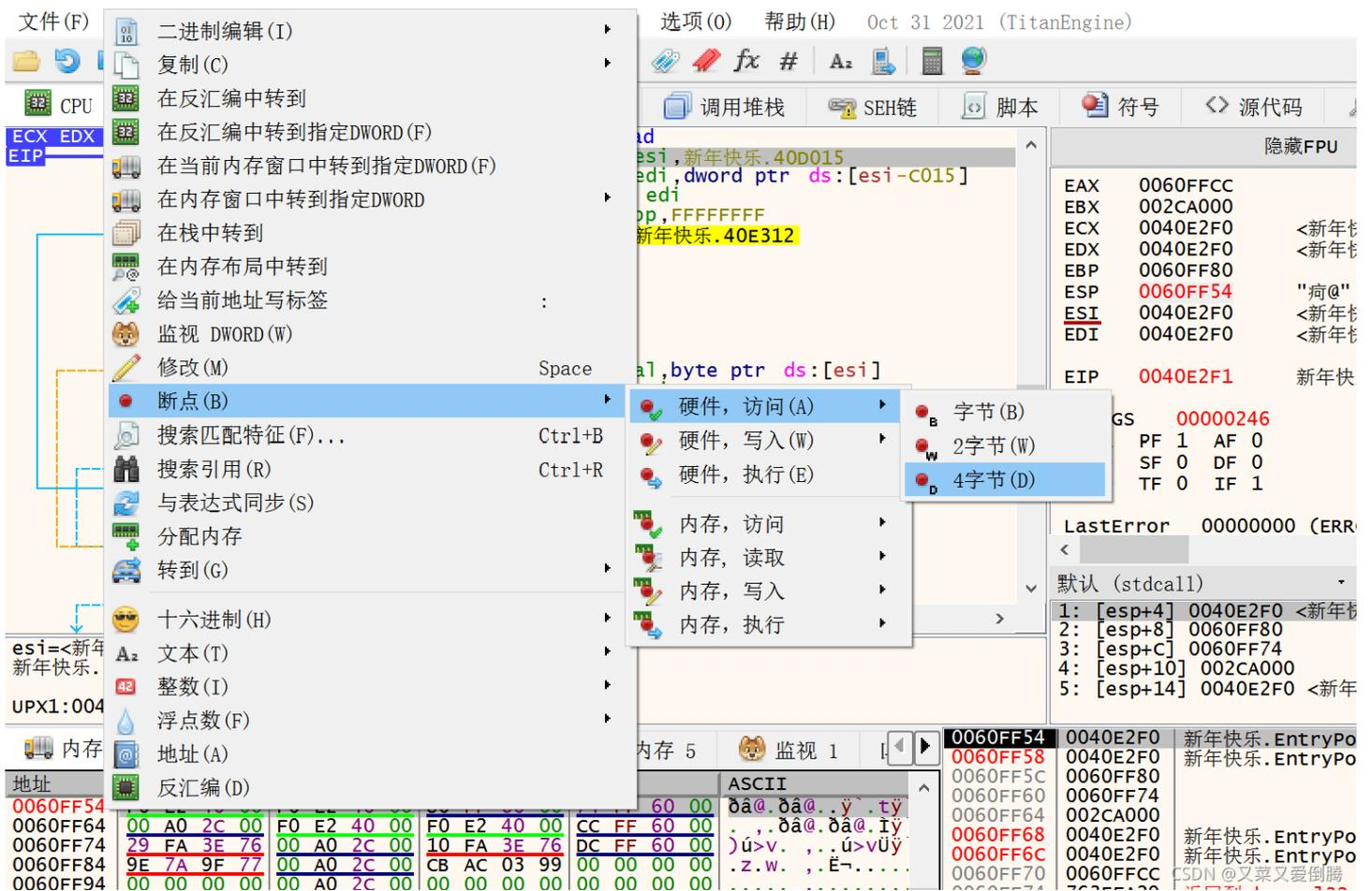
再次F9运行程序后，程序停下来的位置上即popad-壳代码结束位置。在下面大跳转jmp处F2下断点。继续F9运行程序，直到jmp断点处，F7单步步进，找到OEP
