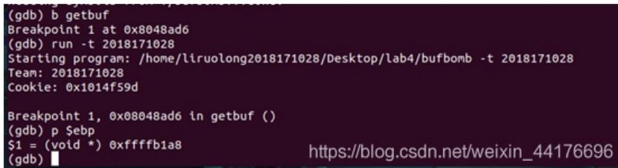
rbp为 `ffffb1a8` 那么根据上面画的getbuf栈帧图，buf起始地址为 `ffffb1a8 - 24 (十进制) = fffffb190`，小端表示: `90b1ffff`
