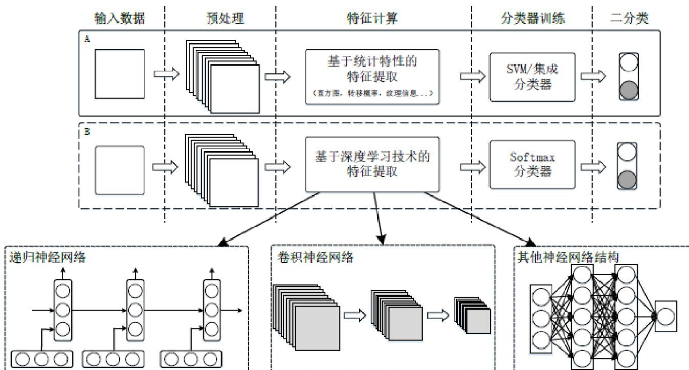
随着自适应隐写术等现代隐写技术的发展，基于手工特征设计的隐写分析方法变得愈发困难。实际上，深度学习技术已经在隐写分析中得到了很好的运用，检测效果已经超过了基于手工特征设计的传统隐写分析方法。
