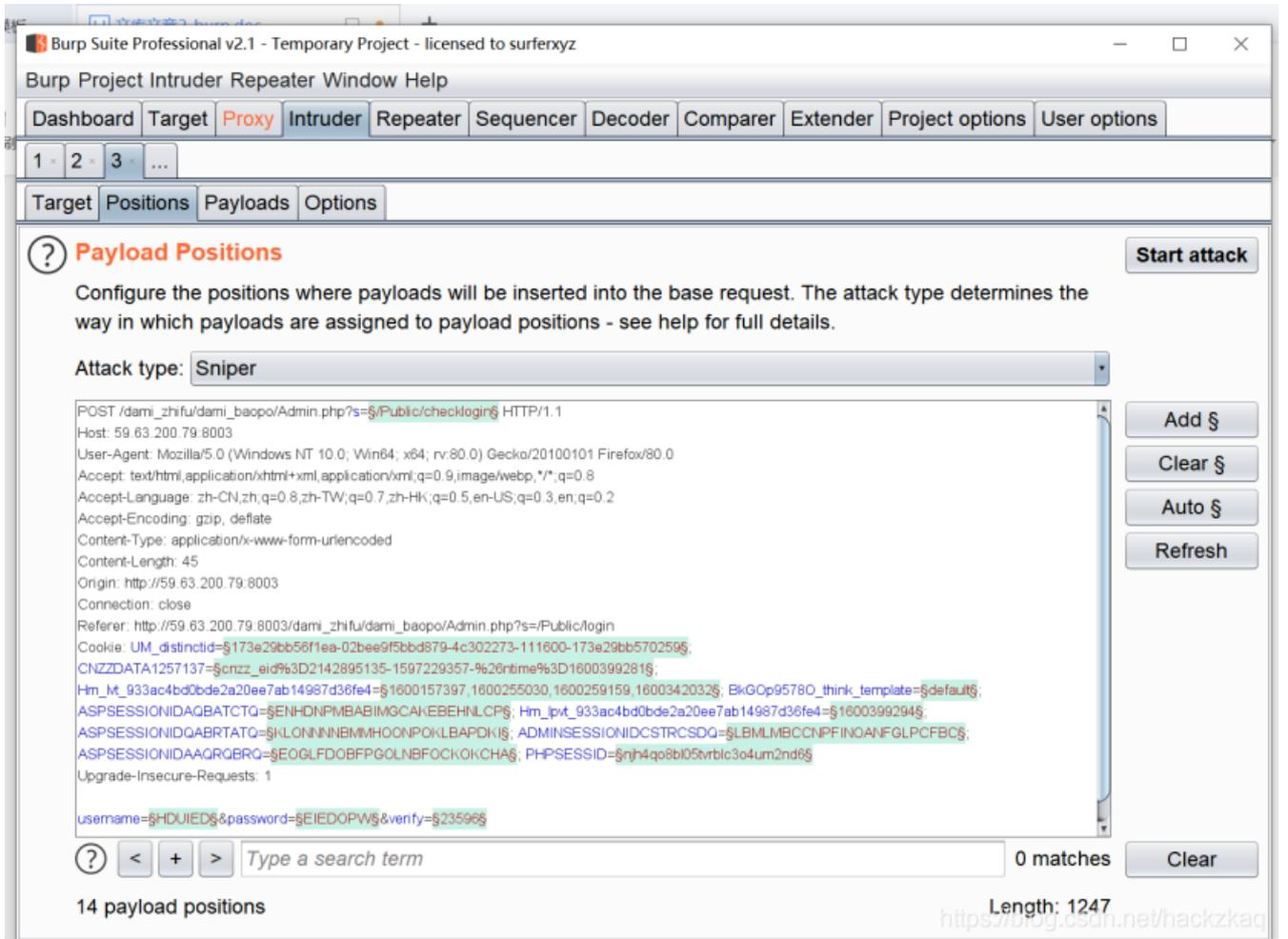
4.因为我们了解到Burp Intruder攻击的基础是围绕刚刚发送过来的原始请求信息，在原始信息指定的位置上设置一定数量的攻击Payload，通过Payload来发送请求获取应答消息。
