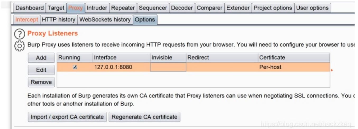
当我们在实际使用中，可能需要同时测试不同的应用程序时，我们可以通过设置不同的代理端口，来区分不同的应用程序，Proxy监听即提供这样的功能设置。
