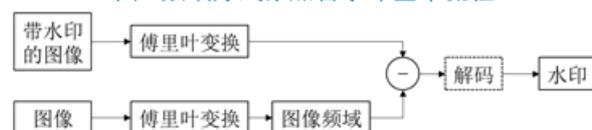
图2 频域方式提取水印基本流程
