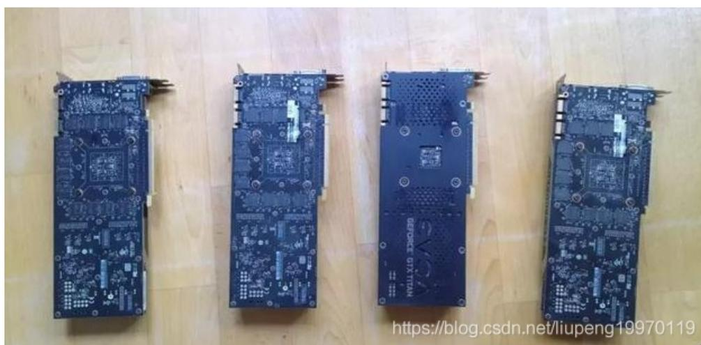
选购GPU有三大注意事项：性价比、显存、散热。使用16bit的RTX 2070或者RTX 2080 Ti性价比更高。除了GPU核心，显存（GPU RAM）也是不可忽视的部分。RTX比GTX系列显卡在显存方面更具优势，在显存相同的情况下，RTX能够训练两倍大的模型。通常对显存的要求如下：
