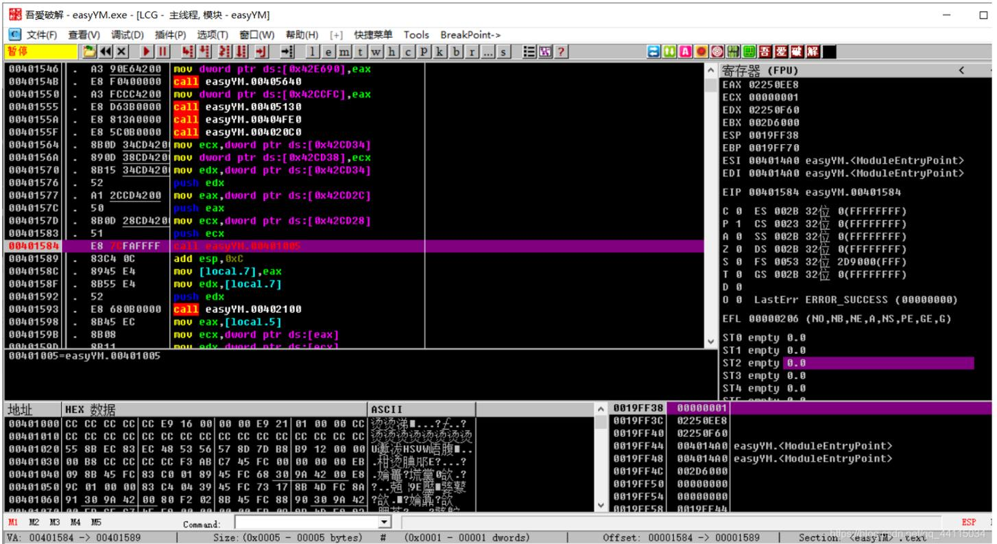
我们在这里调用主函数的地方设置断点，修改一下汇编代码，调用之前的关键代码。
