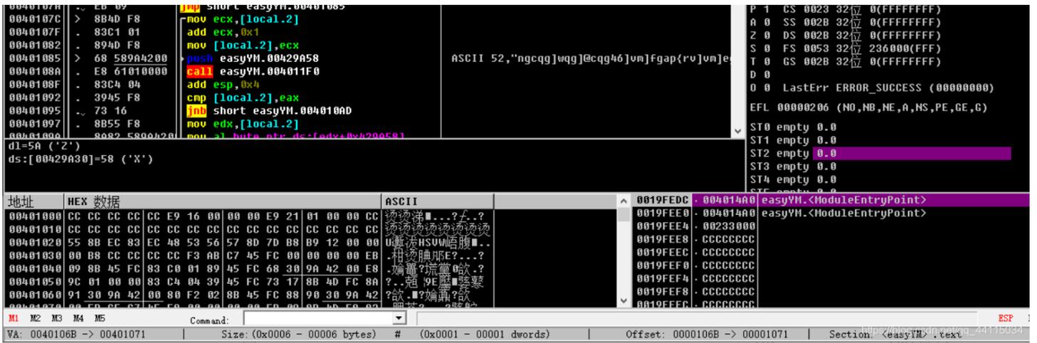
随后发现在此处每次取出字符串中的一个字符与2异或，然后替换原来的字符串。设置断点跟踪查看即可得到替换后的字符串。
