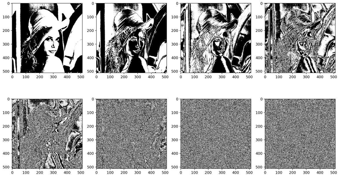
可以看到，位平面越高包含的原图像信息越多，对图像的灰度值贡献越大，并且相邻比特的相关性也越强，反之则相反。LSB最低位平面基本上不包含图像信息了，类似随机的噪点/噪声，因此，可以在此处填入水印/秘密信息。
