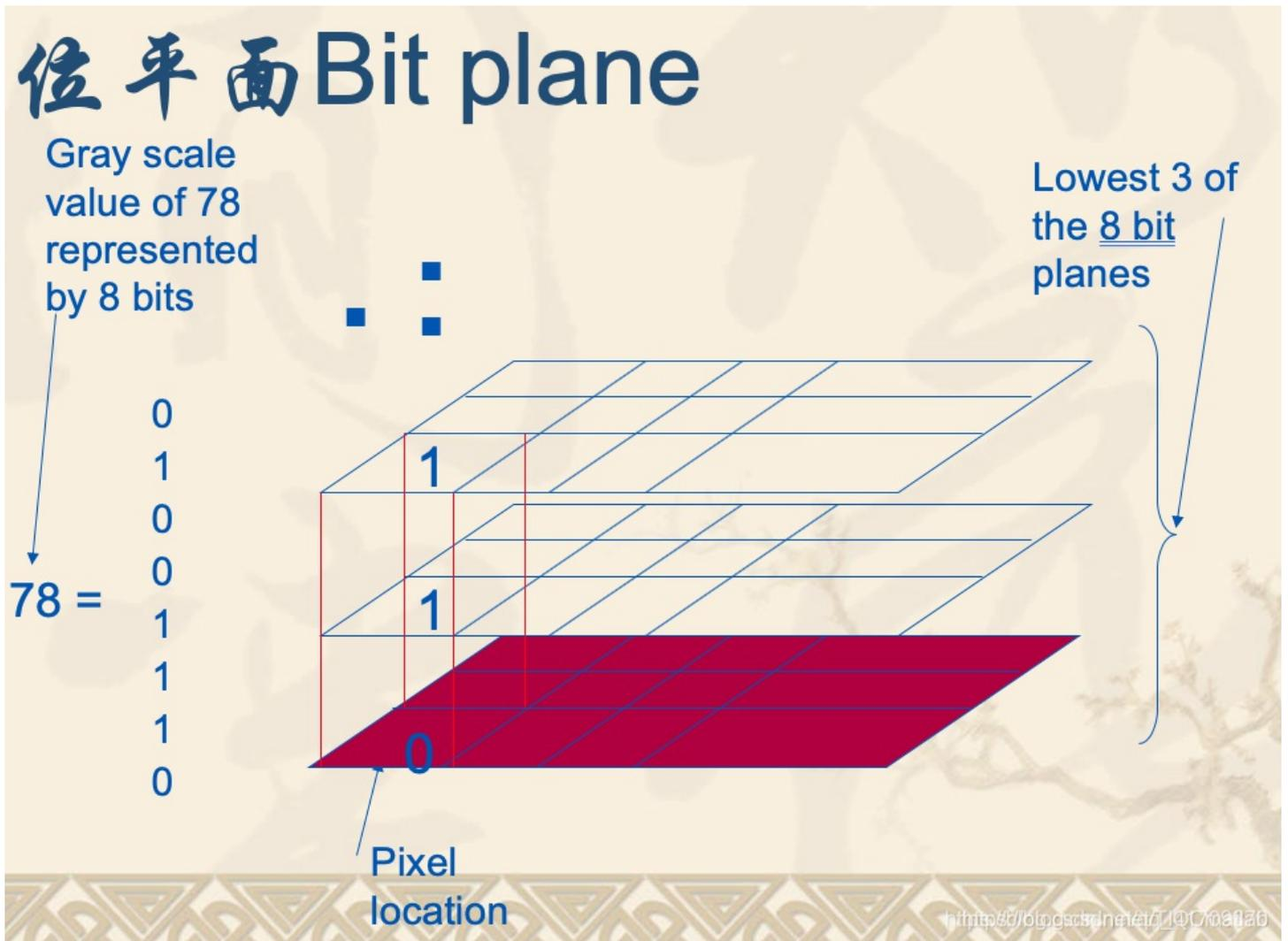
灰度化的图像为单通道格式存储像素，每个像素值在0~255内，而像素的位平面则是对应二进制的像素的各个位。以上图为例，某个像素的值为78，其二进制01001110，从左到右位权依次降低，最左边为最高有效位（MSB，其位权为 $2^7$ ）
