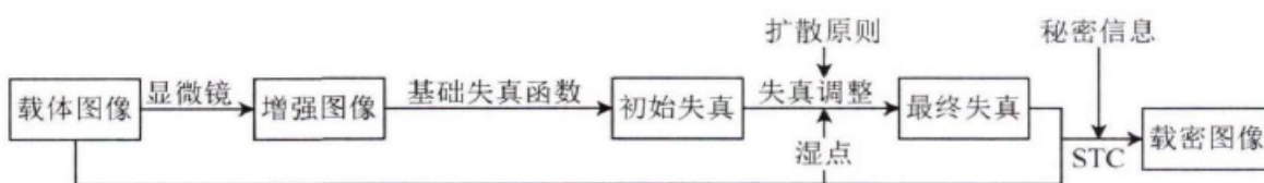
图 3.2 微尺度失真隐写模型流程
