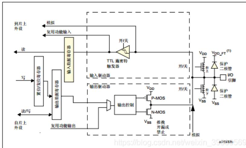
这张图, 完整的展示了GPIO的工作方式, 特别说明, 这只是一个引脚, 在STM32F407VE上, 每16个为一组, 像这样的一组, STM32F407VE有好几组(GPIOA、GPIOB、GPIOC...自己去找找吧, 我就不多说了)。
