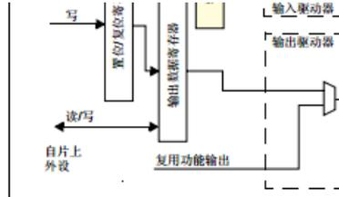
输出数据寄存器的数据还会来自片上外设，如USART1，会使用PA9和PA10来传输数据。设计成这么复杂，目的只有一个，在当USART1工作时，可以通过关闭从置位和复位寄存器到输出数据寄存器的通道，来防止用户对片上外设的输出操作产生干扰。
