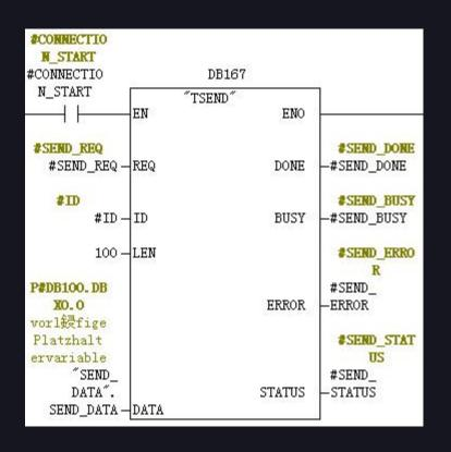
参数 声明 数据类型 存储区 描述 REQ INPUT BOOL I、Q、M、D、L 控制参数REQUEST在上升沿开始发送作业。数据从由DATA和LEN指定的区域。
